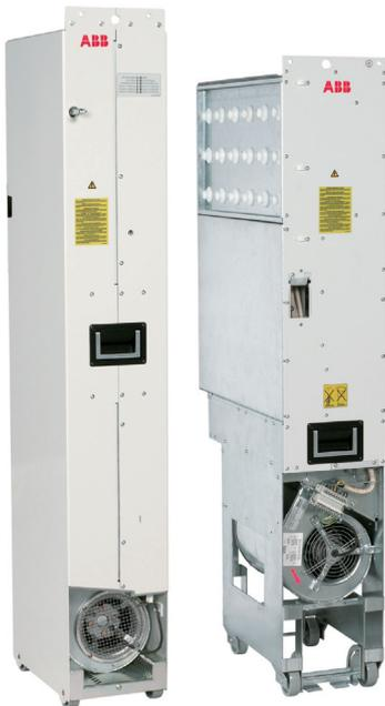
这种结构包括独立的IP00供电模块和逆变模块。这种模块具有极紧凑的书架式结构使传动单元的宽度极具竞争力。模块底部的轮子使得操作非常容易。模块通过快速连接器与独立的电缆连接，这样只是松开几个螺栓就能迅速方便的卸下模块，而不需要松开电缆。逆变模块和供电模块是并排连接的。
